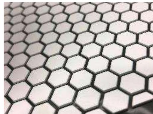
スライスした硬質発泡体を平面方向に独立した島状にカットし
