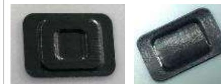
表皮材に炭素繊維、コア材として硬質発泡体を使用した構造
