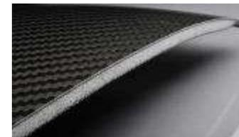
発泡体の気泡セルによる立体的な多数のウェブによる構造
